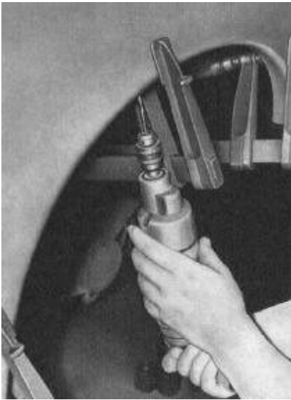
Bild K 16. Nietlöcher bohren
