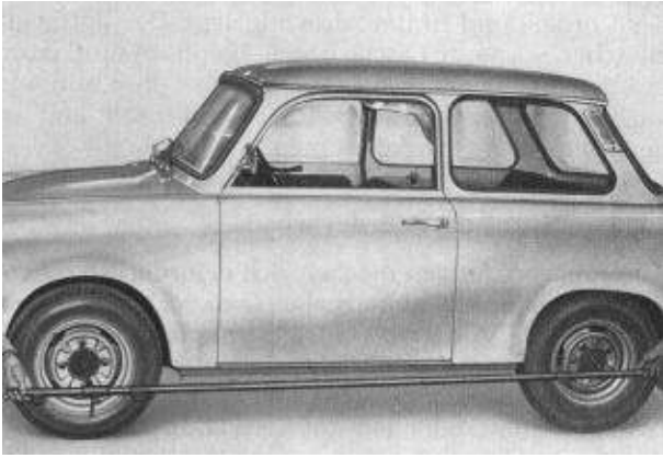
Bild F 22. Radstand überprüfen
