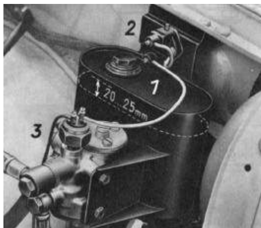
Bild H 15. Hydraulikölbehälter
