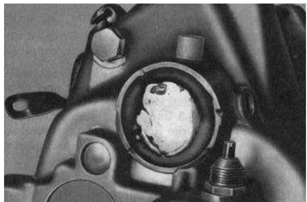
Bild G 20. Farbmarkierung am Ausgleichgetriebe
