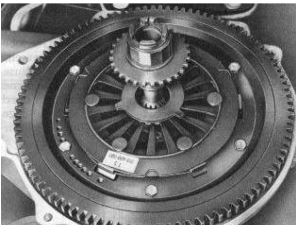
Bild M 74. Mitnehmerscheibe zentrieren
