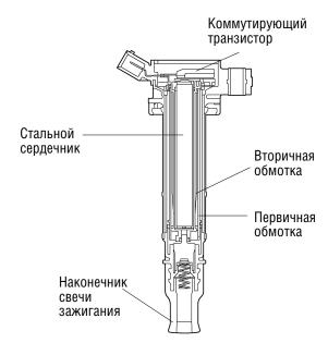
Катушка зажигания в разрезе
